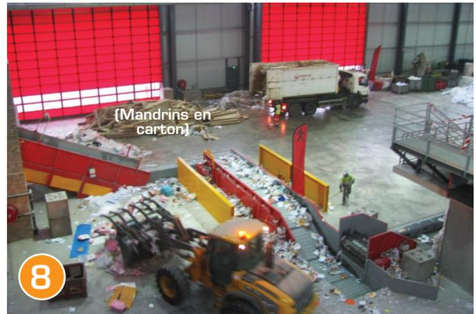
8 Ce convoyeur peut aussi être alimenté d'autres déchets par des engins (ici un chargeur). Des mandrins<sup>1</sup> et autres déchets de papiers sont stockés provisoirement afin de massification.
