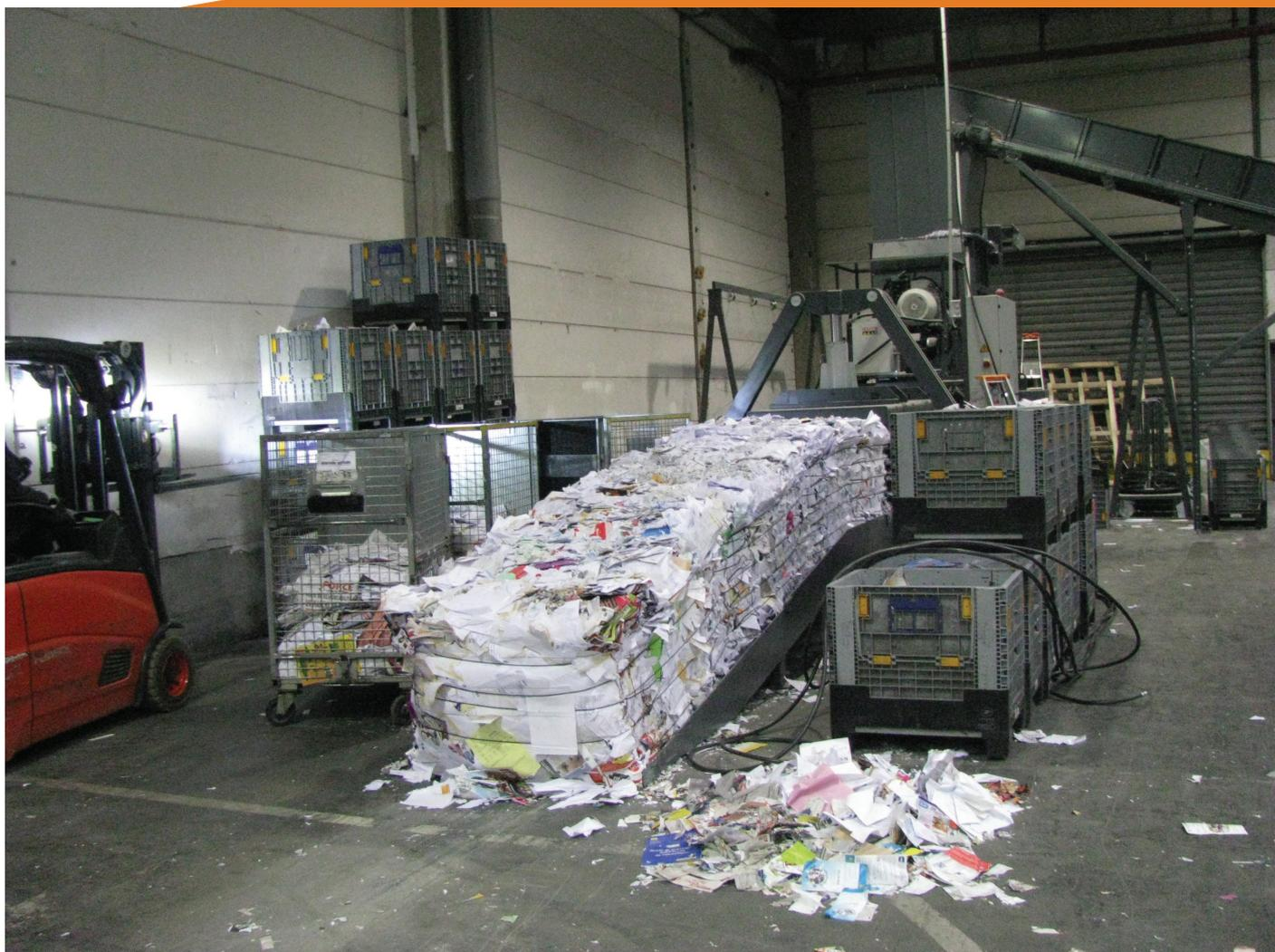
Presse à balles dans un établissement de l'ESS
