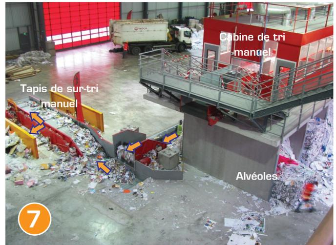
7 Les déchets restant sur le tapis sortent pour un sur-tri manuel sur un convoyeur au sol
