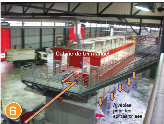
6 Notez que l'accès à la cabine de tri se fait aussi par une coursive en hauteur, évitant ainsi les engins au sol (et les risques de collision)
