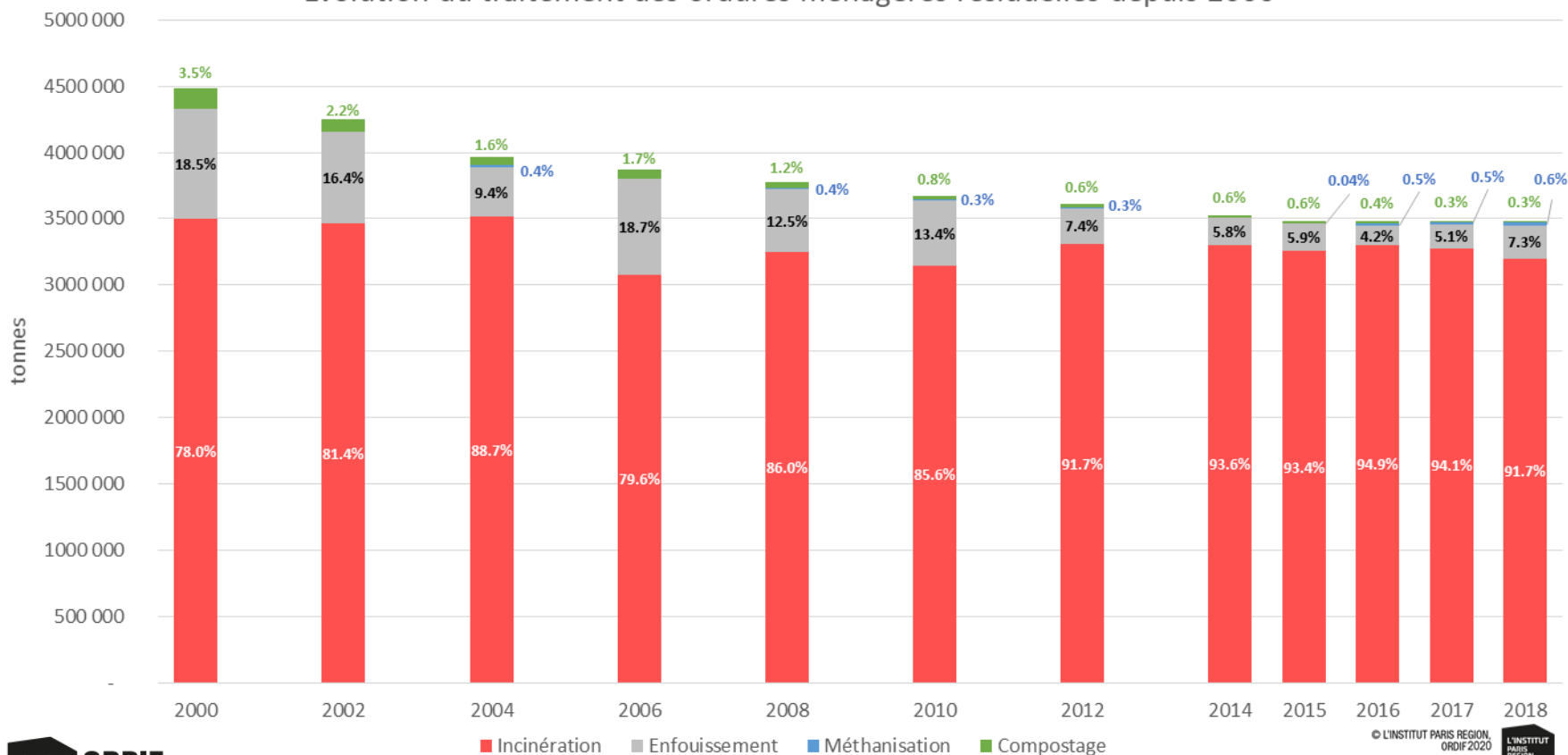
Evolution du traitement des ordures ménagères résiduelles depuis 2000
